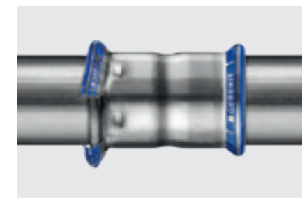
Pagal spalvotus indikatorius paprasta pastebėti neužspauštą Mapress jungtį, prieš atliekant bandymą slėgiu.
