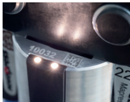
1) Geberit ACO 203plus, ECO 203 ir ACO 203XLplus integruota lemputė presuojamam taškui apšviesti užtikrina gerą matomumą dirbant tamsiuose kampuose.
